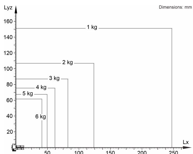
KR 6 R700 Z200 是为 3 kg 的额定负载而设计的，以便最佳利用机械手的性能和动态性。通过减小负载间距，也可以使用高达最大负载能力的更高负载。特殊的负载情况必须用 KUKA.Load 进行检查。如果需要详细咨询，请联系 KUKA 支持部。
