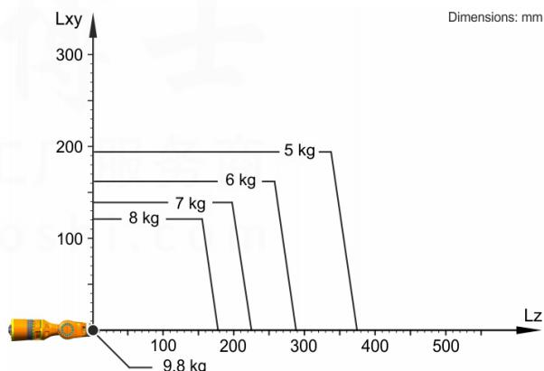
KR 8 R2010-2 设计用于额定负载能力 8 kg, 以便最佳利用机器人的性能和动态性能。通过减小负载间距, 也可以使用高达最大负载能力的更高负载。特殊的负载情况必须用 KUKA Load 进行检查。如果需要详细咨询, 请联系 KUKA 支持部。
