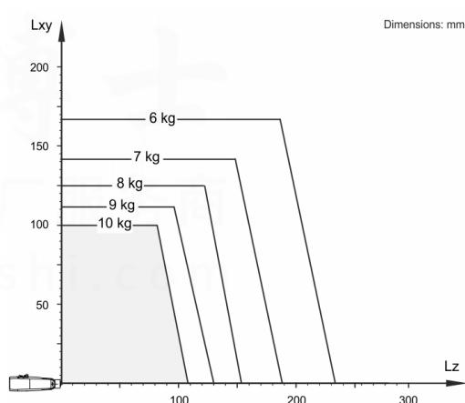
KR 10 R900 WP 设计用于额定负载能力 5 kg，以便最佳利用机器人的性能和动态性能。通过减小负载间距，也可以使用高达最大负载能力的更高负载。特殊的负载情况必须用 KUKA Load 进行检查。如果需要详细咨询，请联系 KUKA 支持部。
