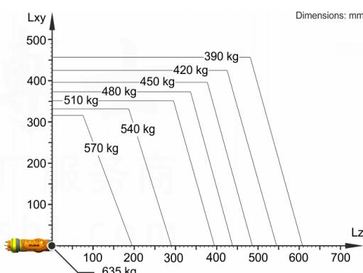
KR 510 R3080 设计用于额定负载能力 510 kg, 以便最佳利用机器人的性能和动态性能。通过减小负载间距, 也可以使用高达最大负载能力的更高负载。特殊的负载情况必须用 KUKA Load 进行检查。如果需要详细咨询, 请联系 KUKA 支持部。
