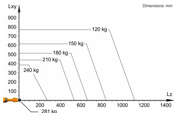
KR 210 R3100-2 设计用于 210 kg 的额定负载能力，以便最佳利用机器人的性能和动态性。仅在质量重心位置为 0 mm 且安装了针对负载规格优化过的附加负载时，281 kg 的最大负载能力才适用。必须用 KUKA.Load 或 KUKA Compose 检查特殊的负载情况。如果需要详细咨询，请联系 KUKA 支持部。
