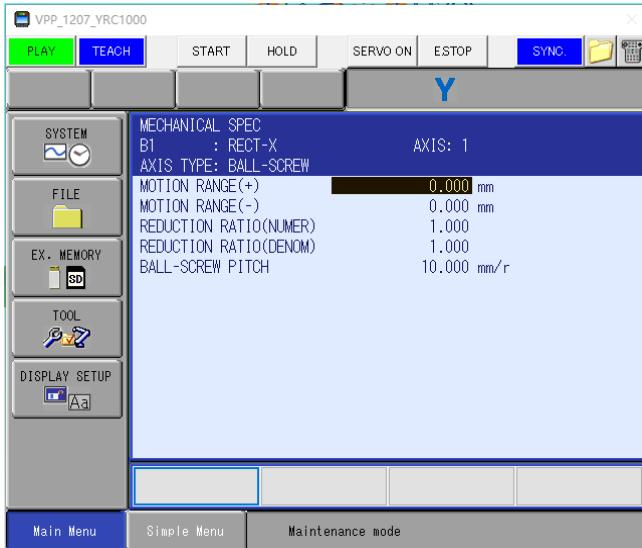
根据参数表设定型号、加速比、转速等后按回车
